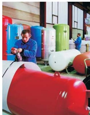
Druckbehälterbau bei der Maschinen- und Behälterbau GmbH
